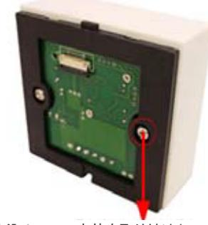
専用埋め込みBoxへ本体を取り付け(M4\*30ネジ)
